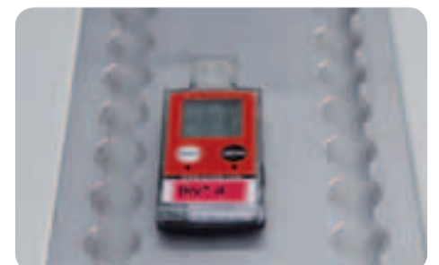
Der Datenlogger von tkv* dokumentiert die Laderaum-Temperatur im Auflieger.
