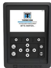
Nach Abschluss der Systemstartsequenz wird die Standardanzeige dargestellt und die Maschine läuft im Dieselbetrieb (wenn kein elektrischer Standby erkannt wurde).
