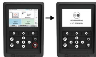
Nach ein paar Sekunden wird wieder die Standardanzeige dargestellt und das Start-Stop-Symbol ist aktiviert. Die Maschine läuft jetzt im Start-Stop-Betrieb. Falls der Start fehlschlägt, kehrt die Maschine in den Dauerbetrieb zurück. Prüfen Sie auf Alarme und versuchen Sie es erneut.
